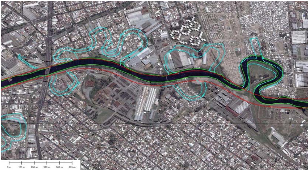
Figura II-15. Rectificaciones proyectada (rojo), ejecutada (verde). Único meandro remanente en el sector.
