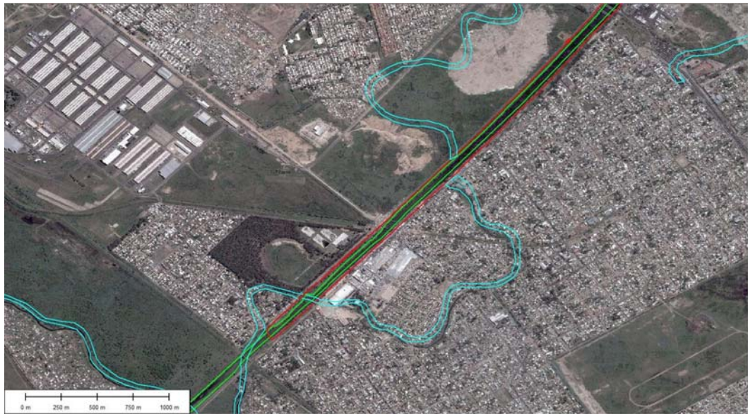
Figura II-14. Antiguo curso del Riachuelo y actual traza rectificada (sector de Lomas de Zamora).
