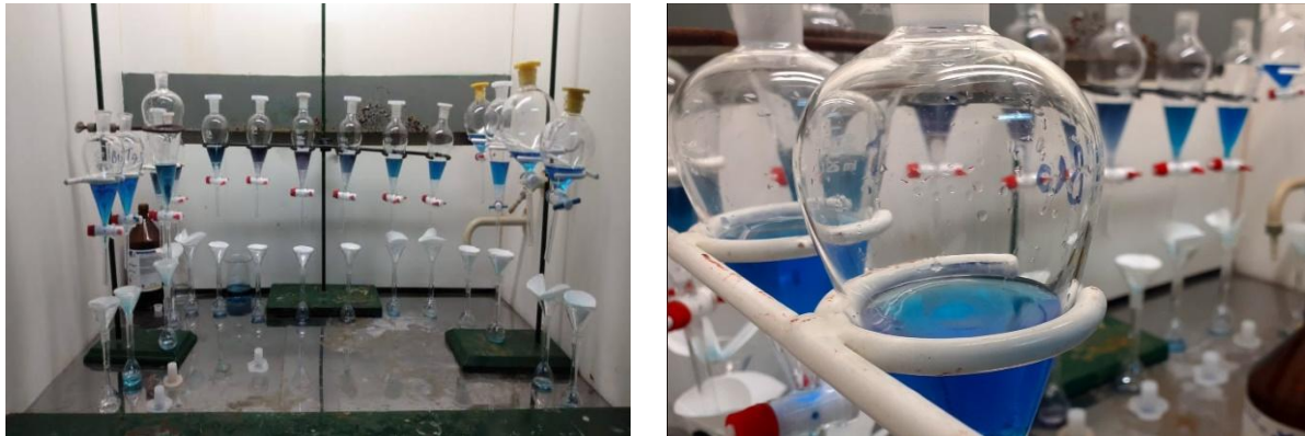
Foto LA11: Determinación de detergentes por extracción con cloroformo
