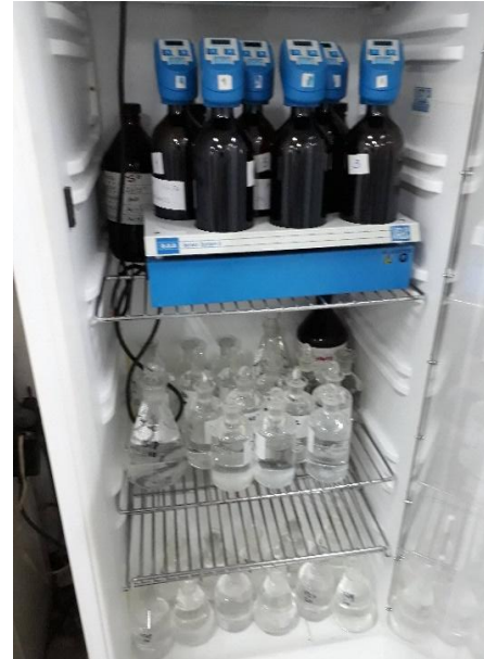
Foto LA 2: Frascos winklers, incubación para DBO_5
