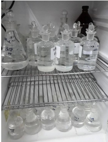
Foto LA 2: Frascos winklers, incubación para DBO_5
