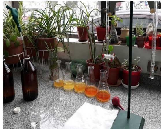
Foto LA3: Determinación titulométrica de Sulfuros, previa coagulación de la muestra para eliminar interferencias.
