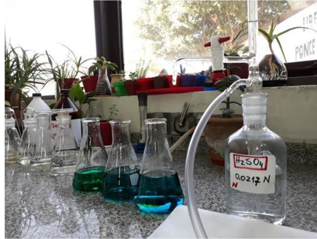
Foto LA4: Destilación y posterior titulación para la determinación de N-NH 3
