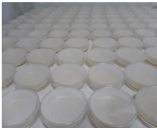
Foto LA6: Placas con diferentes diluciones luego de la incubación para determinación de UFC/100ml.
