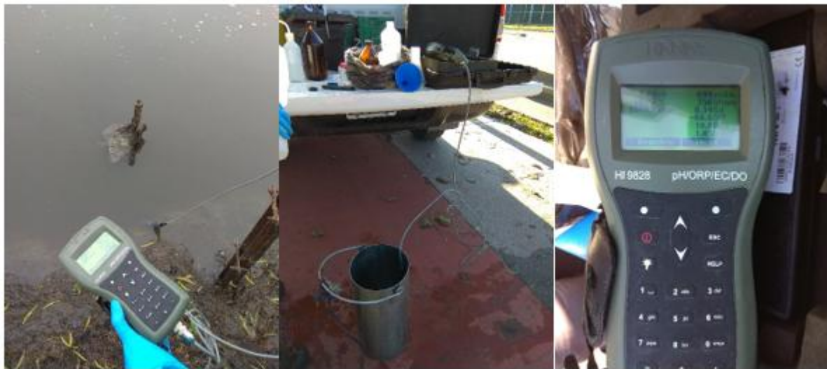
Fotos 1.1.7-8-9 – Detalle de uso y display de sonda multiparamétrica durante la Campaña.
