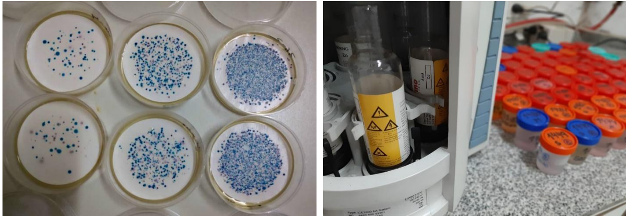
Fotos 1.1.12-13- Placas con diferentes diluciones luego de la incubación para determinación de UFC/100ml (izq.) y determinación de metales por espectroscopia de absorción atómica previa digestión ácida de la muestra (der).
