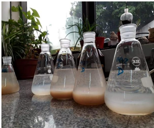
Foto LA3: Determinación titulométrica de Sulfuros, previa coagulación de la muestra para eliminar interferencias.
