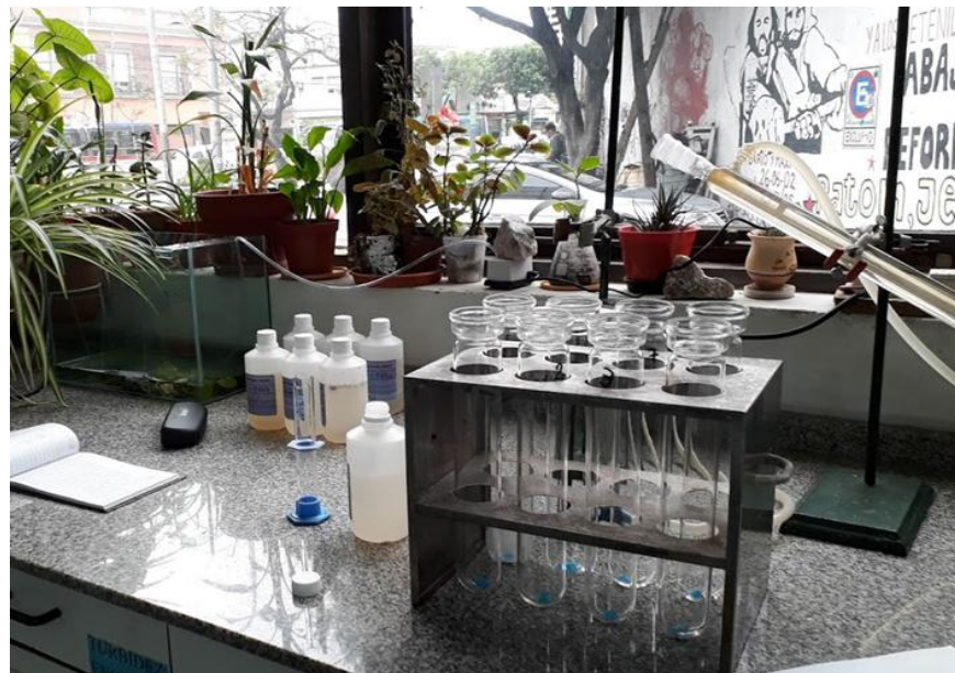
Foto LA10: Preparación de la digestión para nitrógeno total Kjeldalh
