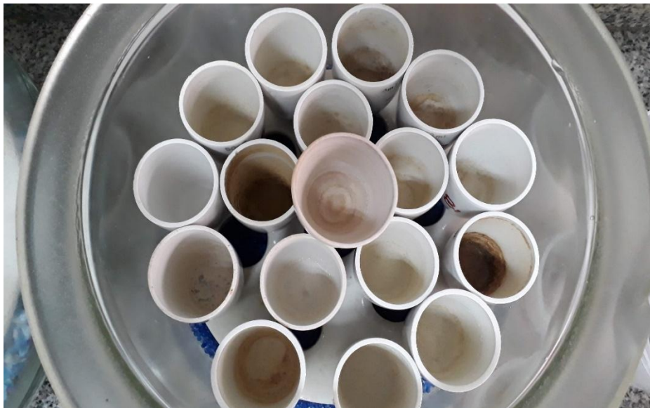
Foto LA7: Muestras evaporadas en crisoles para posterior calcinación en mufla y determinación de sólidos fijos y sólidos volátiles a 550°C
