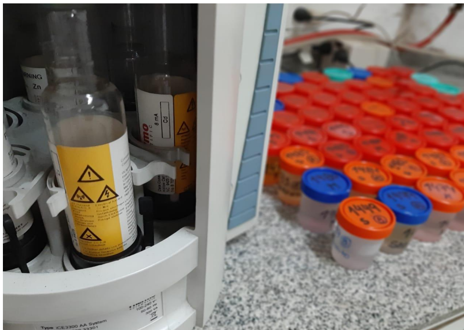
Foto LA8: Determinación de metales por espectroscopia de absorción atómica previa digestión ácida de la muestra.
