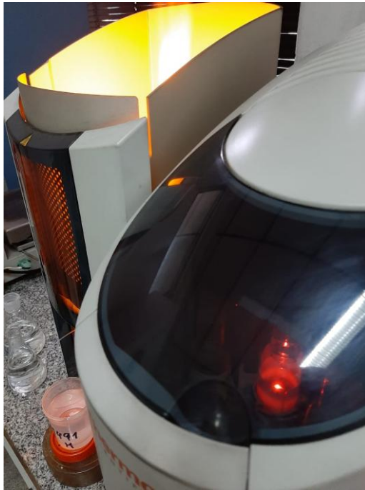
Foto LA9: Equipo de absorción atómica con llama ire-acetileno para determinación de metales
