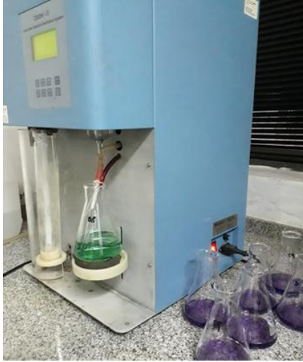
Foto LA4: Destilación y posterior titulación para la determinación de N-NH 3
