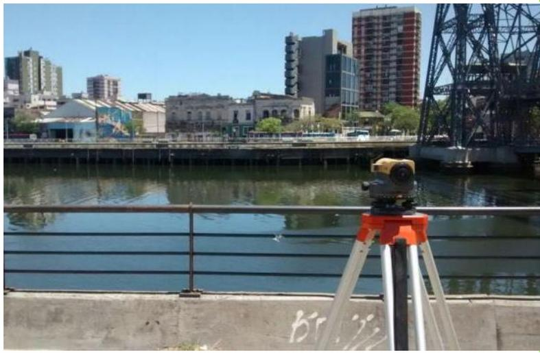
Imagen 6.6.2 Fotografía del Nivel óptico utilizado para la Nivelación.
