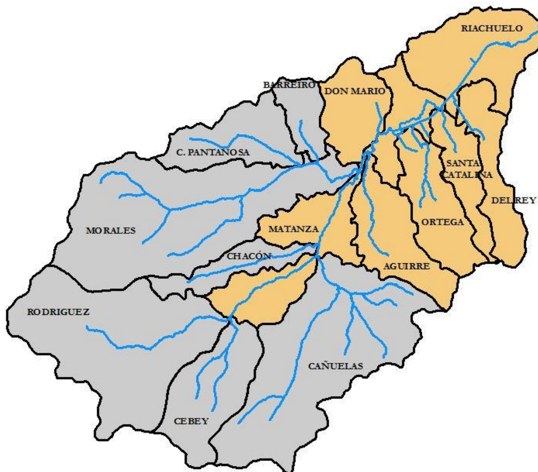
Figura 1.5. Sistema del Matanza–Riachuelo, afluentes de la parte parte baja de la cuenca y sus correspondientes áreas de aporte.
