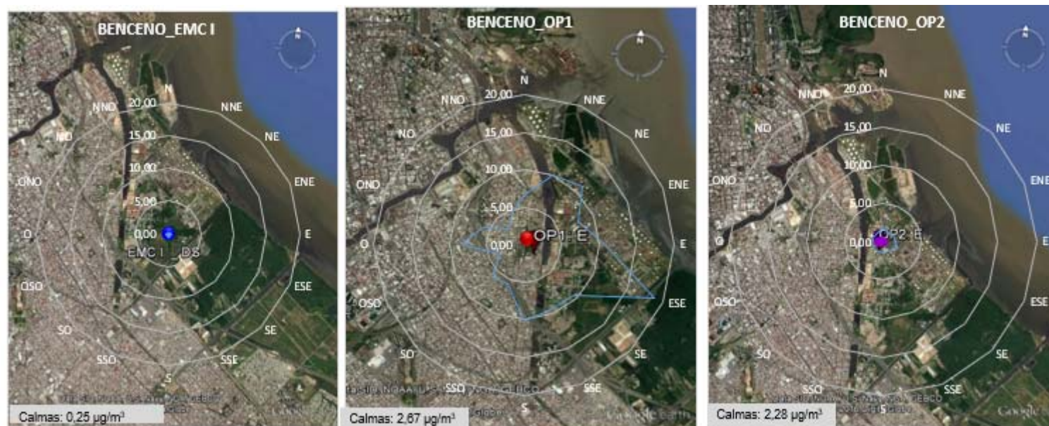
Figura 29. Rosas de contaminantes para benceno medido en la EMC I, OP1 y OP2 en Dock Sud en los meses de marzo - mayo 2023. Se presentan los valores promedio de concentración de benceno ( \mu\text{g}\cdot\text{m}^{-3} ) para las 16 direcciones de viento.
