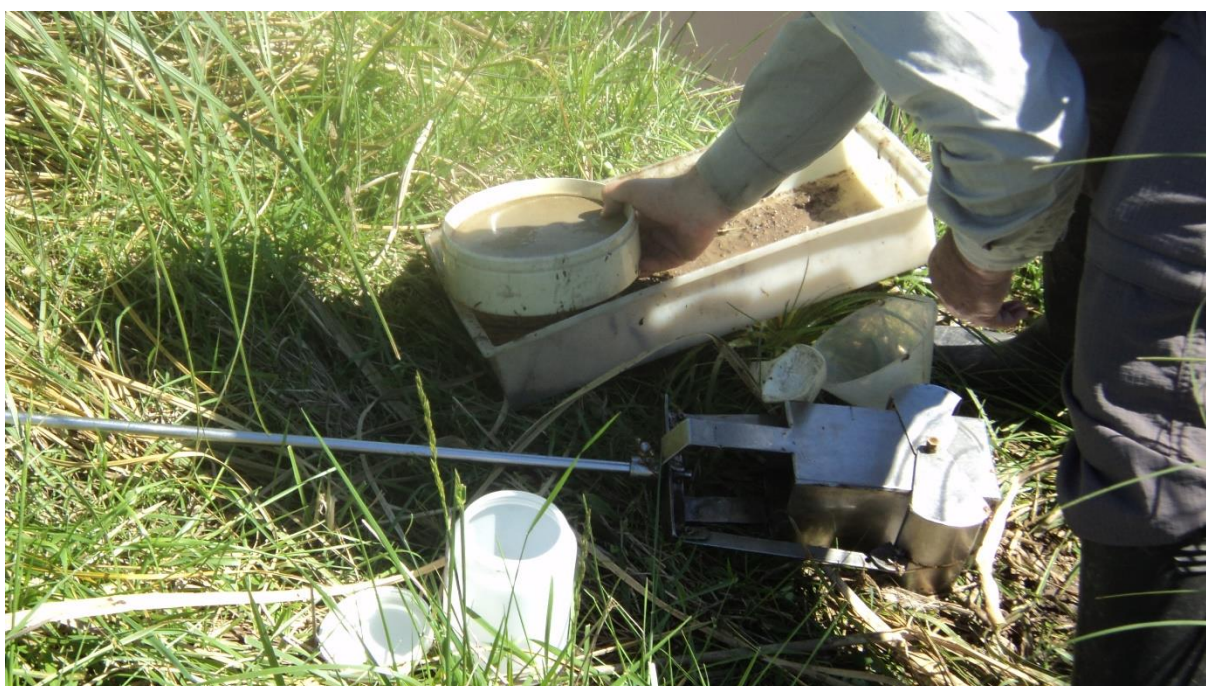
Figura 1.4 y 1.5. Personal del ILPLA, tomando muestras de agua superficial, sedimentos y vegetación (octubre de 2014), para la determinación en laboratorio de los diferentes parámetros bióticos, proceso que se viene realizando en forma sistemática desde el año 2008.
