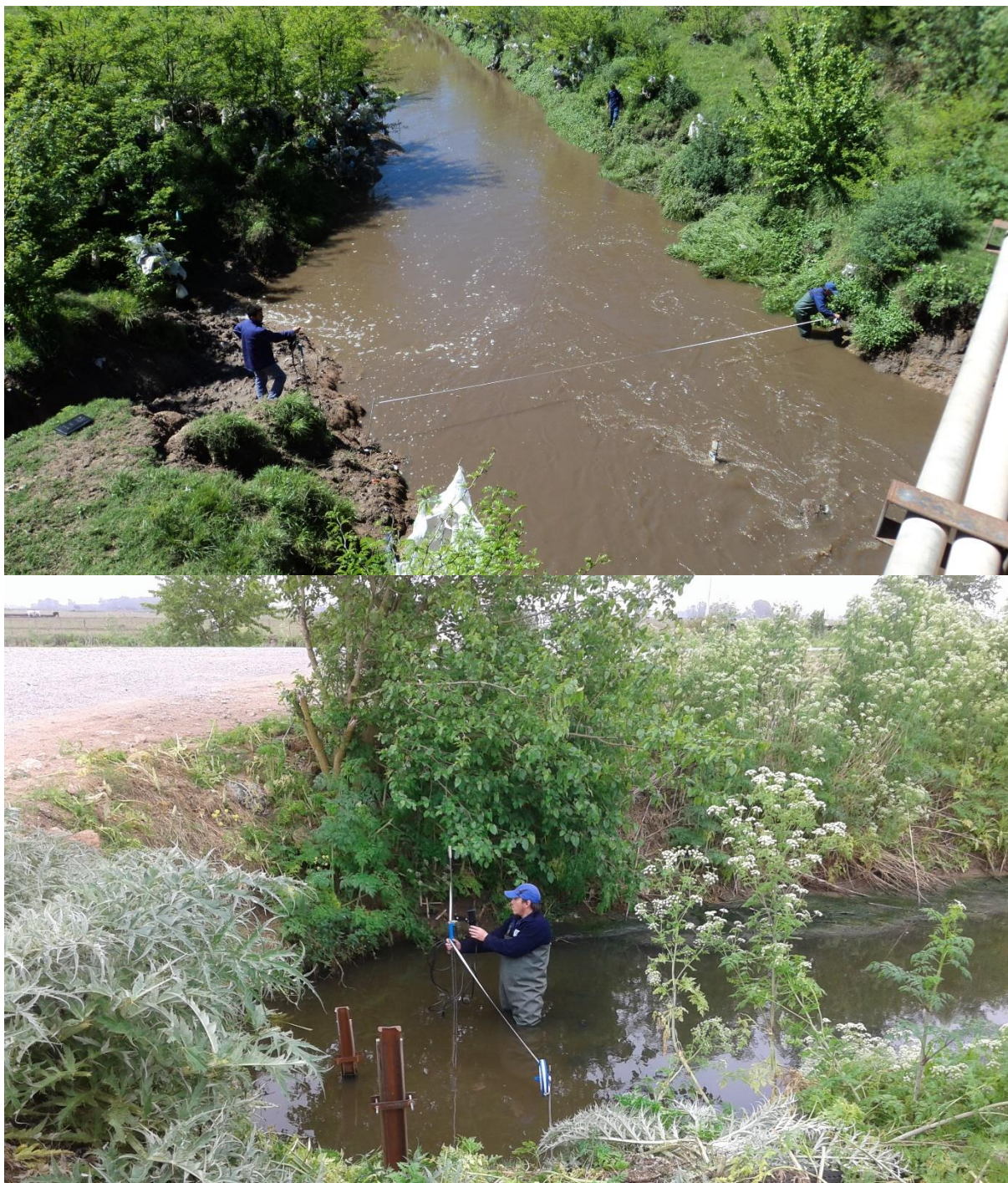
Figura 1.3 y 1.4. Medición de caudales en diferentes cursos superficiales en estaciones que forman parte de la red de estaciones fijas de operación manual de Calidad y Caudal del Agua Superficial de la Cuenca Hidrográfica Matanza Riachuelo operada por EVARSA.
