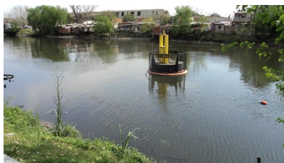
Figura 1.10. Boya de toma de muestras de la Estación Piloto de Control de Caudal y Calidad del Agua Continuo y Automático Regatas Avellaneda.
