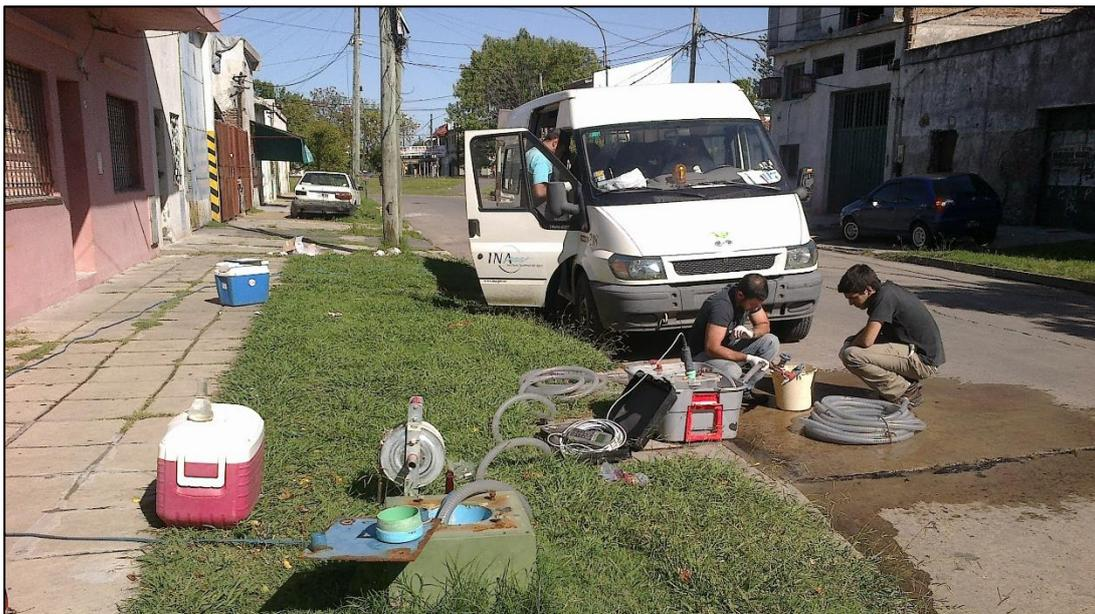
**Figura 2.3.** Programa de Monitoreo de Calidad de Agua Subterránea de la Cuenca Matanza Riachuelo. Purgado y control de parámetros en pozo 29F, Lanús.
