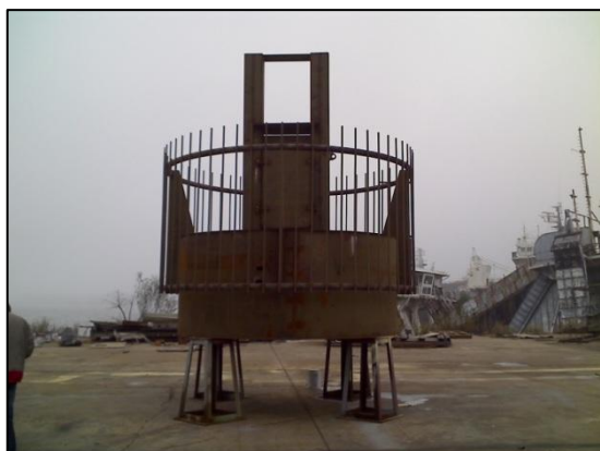
Figura 1.7. Boya de toma de muestras de la Estación Piloto de Control de Caudal y Calidad del Agua Continuo y Automático, Club Regatas Avellaneda.
