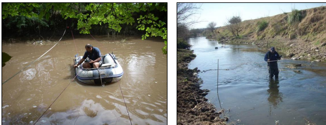
Figura 1.5. Medición de caudales en la Cuenca Matanza Riachuelo.
