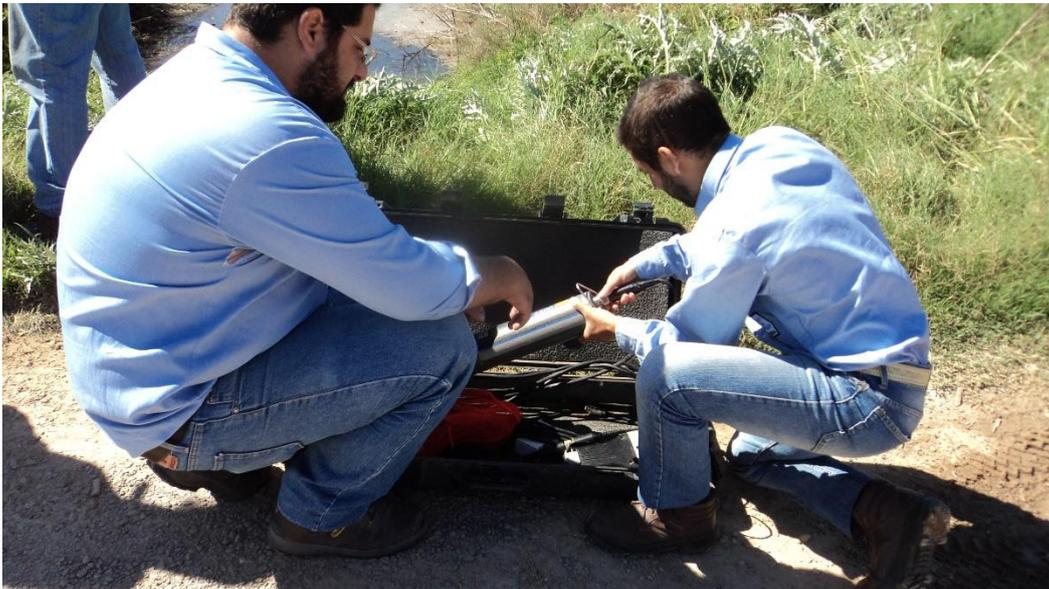
**Figura 1.3 y 1.4.** Medición de caudales contoma simultánea de muestras de agua superficial y medición de parámetros de campo con equipos multiparámetricos en red de estaciones fijas de operación manual de Calidad y Caudal del Agua Superficial de la Cuenca Hidrográfica Matanza Riachuelo realizada por EVARSA.
