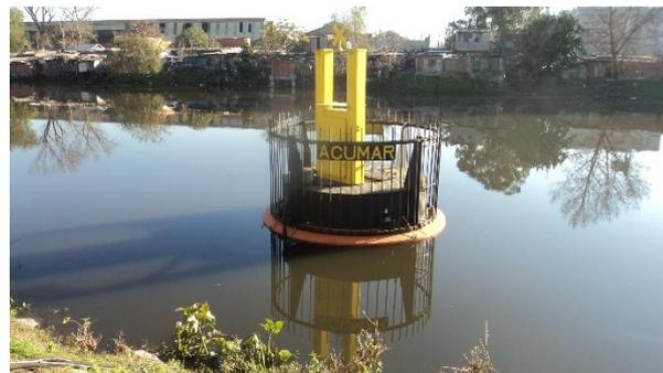
**Figura 1.10.** Boya de toma de muestras de la Estación Piloto de Control de Caudal y Calidad del Agua Continuo y Automático Regatas Avellaneda.
