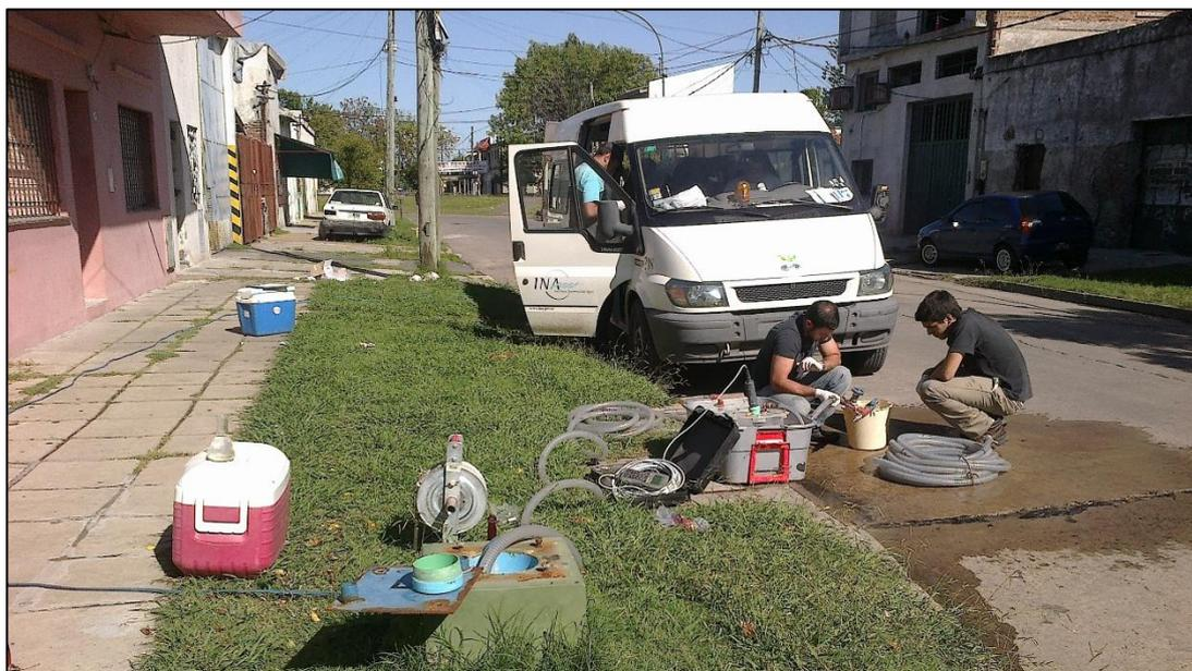
**Figura 2.3.** Programa de Monitoreo de Calidad de Agua Subterránea de la Cuenca Matanza Riachuelo. Purgado y control de parámetros en pozo 29F, Lanús.
