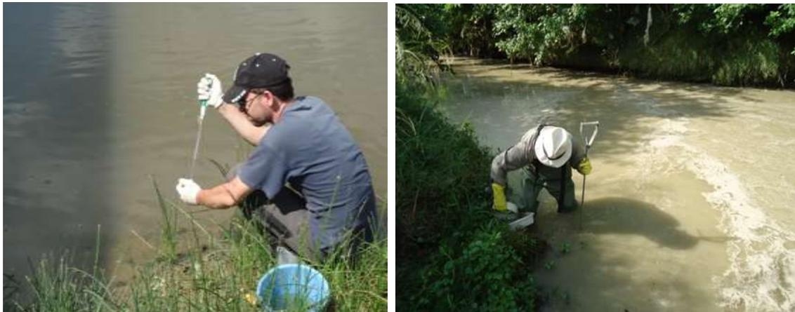
**Figura 1.6 y 1.7.** Toma de Muestras de Agua Superficial para monitoreo de parámetros biológicos y de biodescriptores en la Cuenca Matanza Riachuelo realizada por el ILPLA.
