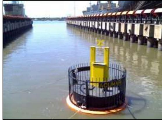
**Figura 1.14.** Boya de toma de muestras de la Estación Piloto de Control de Caudal y Calidad del Agua Continuo y Automático Regatas Avellaneda.
