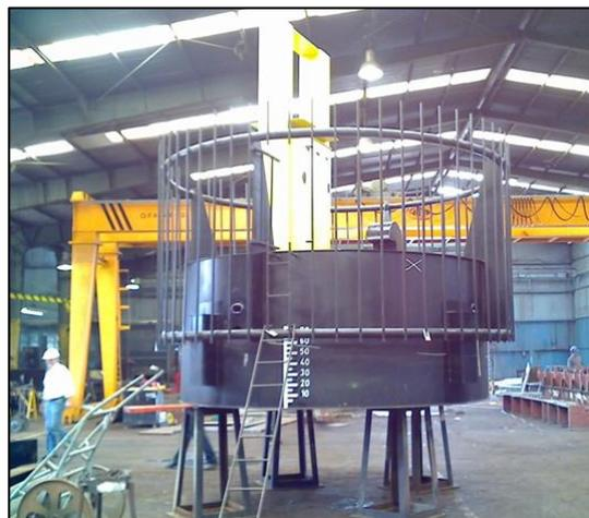
**Figura 1.7.** Boya de toma de muestras de la Estación Piloto de Control de Caudal y Calidad del Agua Continuo y Automático, Club Regatas Avellaneda.
