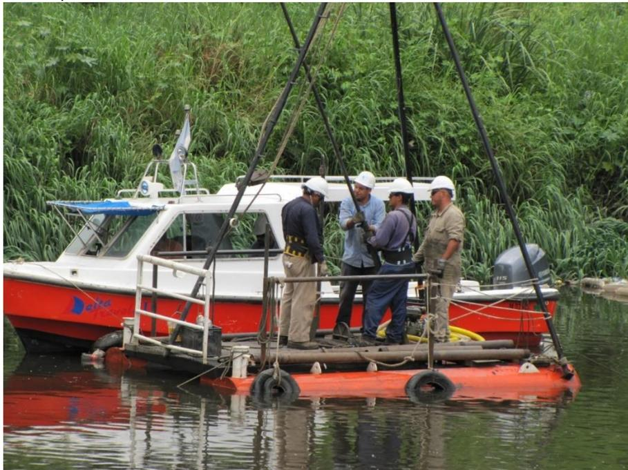
**Figura 6.5.** Ubicación del equipo de trabajo sobre el sitio establecido para sondeos en el Pliego de Especificaciones Técnicas (PET) de caracterización de sedimentos. Extracción de muestra en Sondeo S41.
