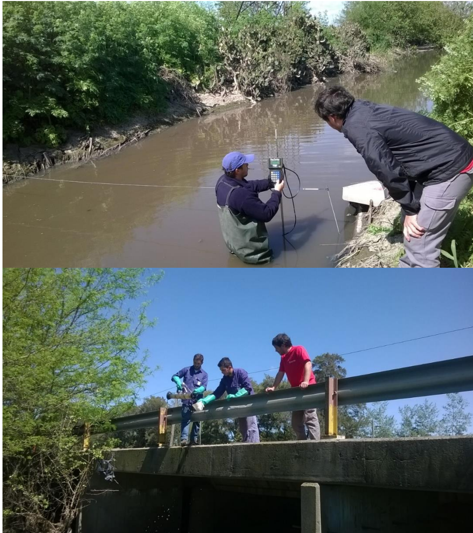
Figura 1.3 y 1.4. Medición de caudales y toma de muestras de agua, en diferentes cursos superficiales, en estaciones que forman parte de la red de estaciones fijas de operación manual de Calidad y Caudal del Agua Superficial de la Cuenca Hidrográfica Matanza Riachuelo operada por EVARSA.
