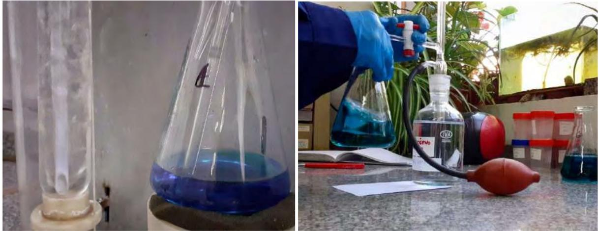
**Foto LA6:** Destilación para la determinación de  $N-NH_3$  y posterior titulación
