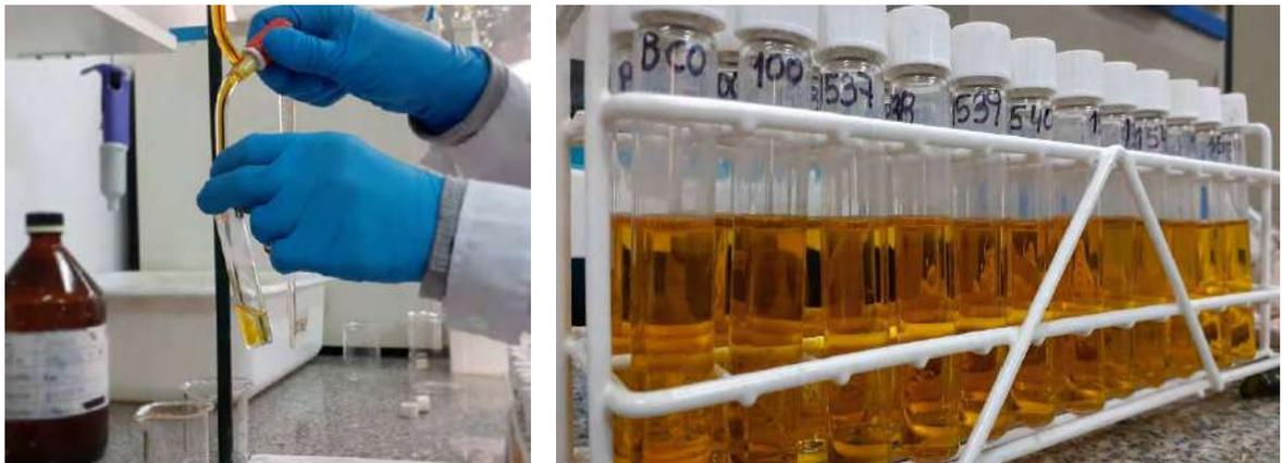
**Foto LA7:** Preparación de la reacción colorimétrica para determinación de DQO.
