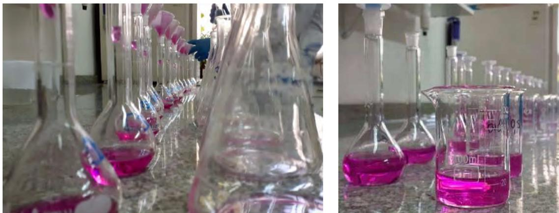
**Foto LA8:** Recuperación post digestión y reacción colorimétrica para determinación de  $P-PO_4$ .
