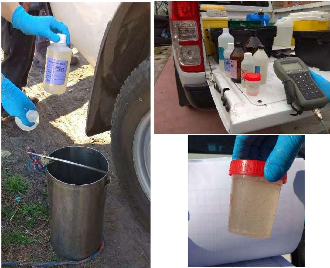
Fotos CA6 – Llenado y rotulado de envases para acopio de la muestra de agua para distintos analitos.
