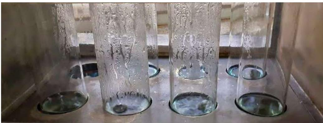
**Foto LA5:** Reflujo en la digestión para determinación de NTK
