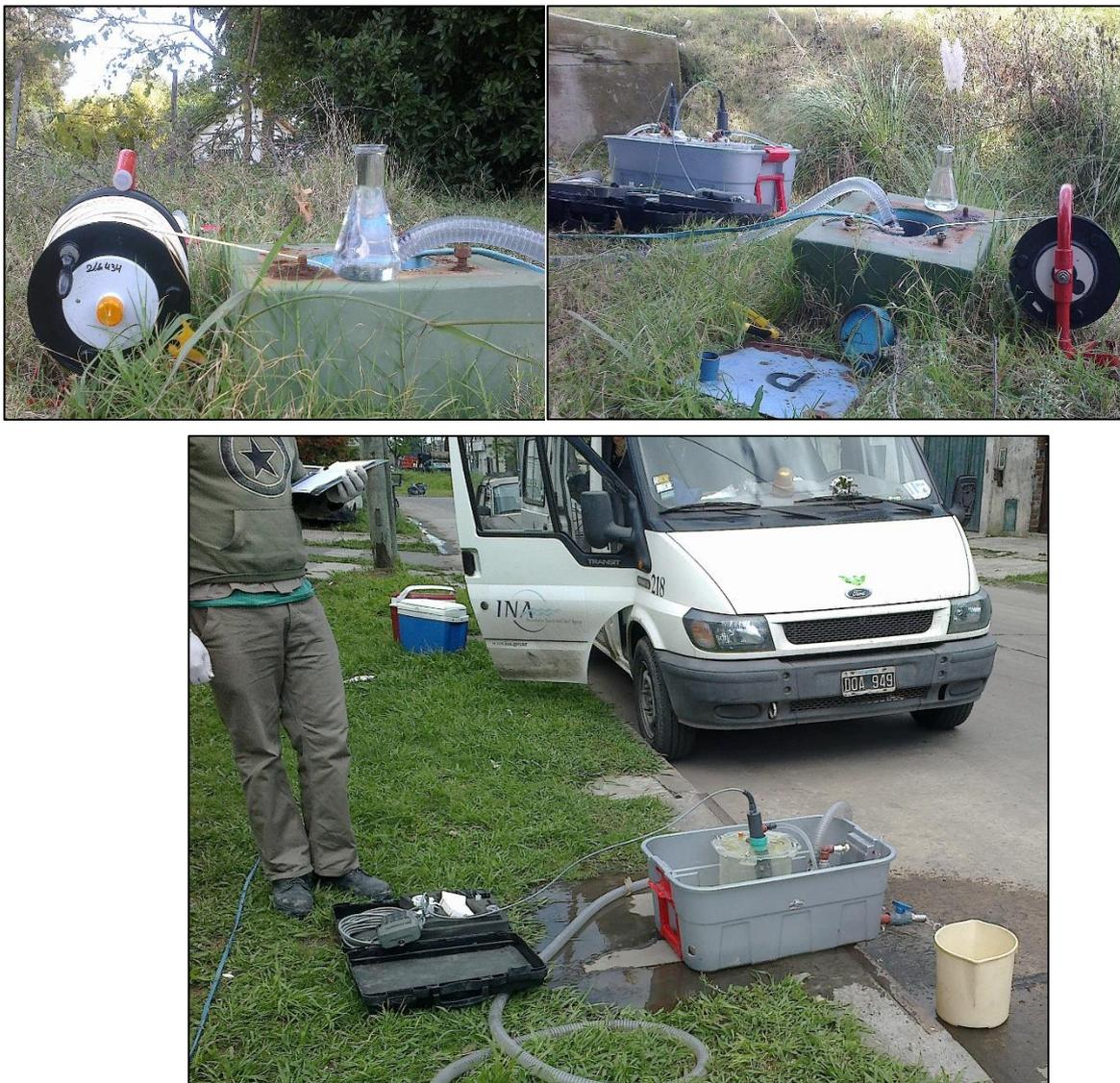
**Figura 2.7** . Imágenes medidas de profundidades y purgado de pozos para muestreo aguas subterráneas ejecutado por el Instituto Nacional del Agua (INA).
