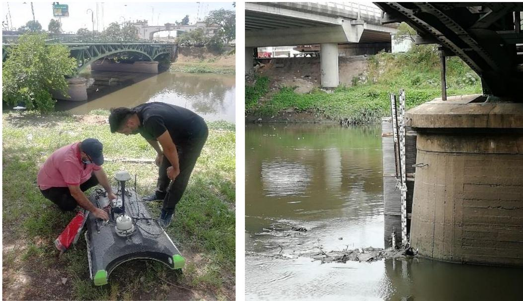
**Figura 7** – Preparación del ADCP para el aforo (izq) y nivel del curso en la EM 17 que registra la regla hidrométrica (der). Fuente: INA.
