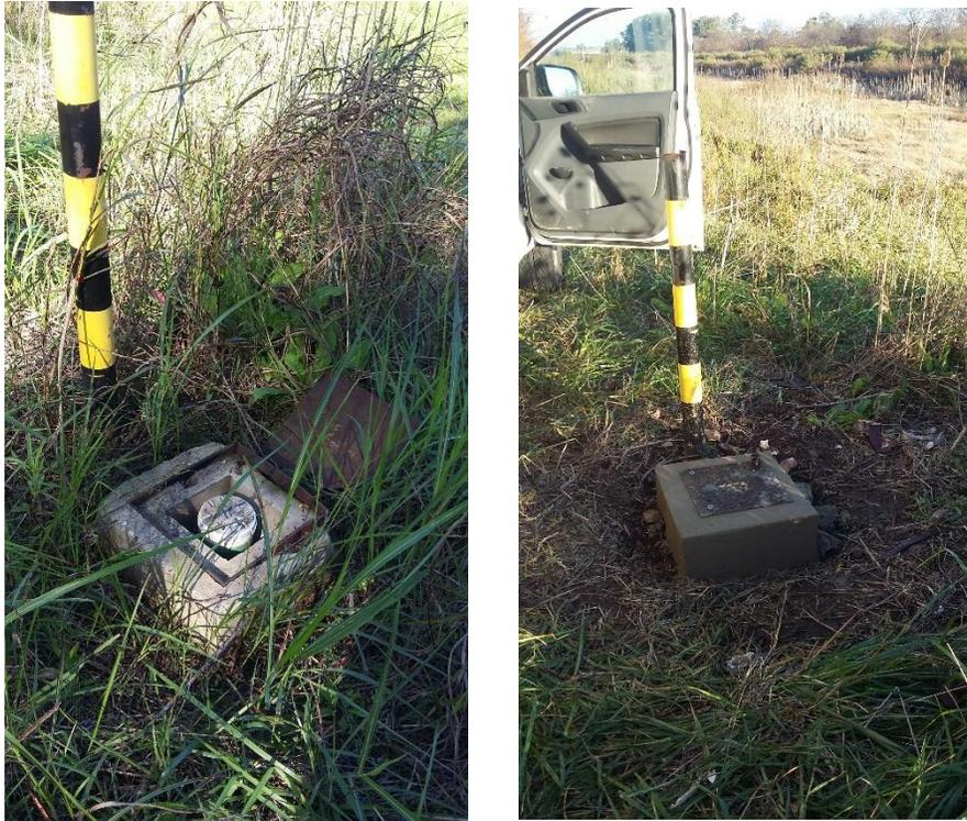
**Figura 3.1.2.** Freatímetro 4F en Marcos Paz, estado original y luego de reparado.
