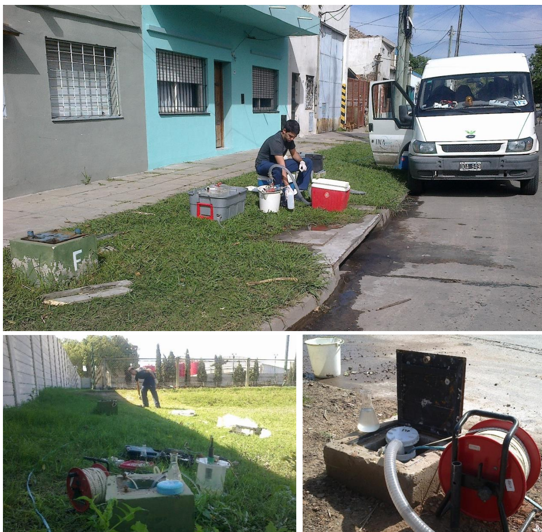
Figura 2.6. Purgado de pozos y muestreo aguas subterráneas ejecutado por el INA en marzo/abril 2014.
