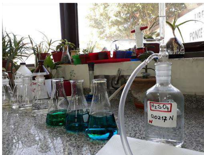
Foto LA4: Destilación y posterior titulación para la determinación de N-NH 3
