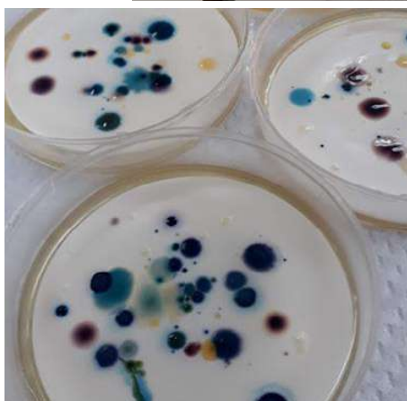
Fotos 11 a 14. Recuperación de las muestras para la calcinación (der). Set de envases para análisis en laboratorio (izq). Abajo: Placas para determinación microbiológica de unidades formadoras de colonias.
