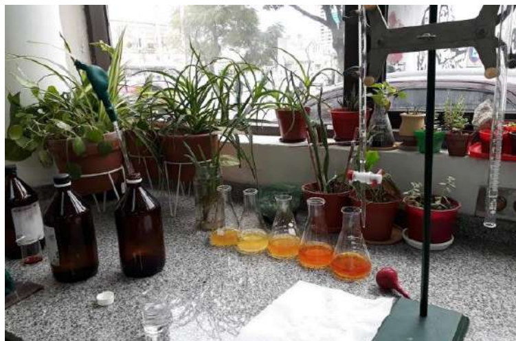
Foto LA3: Determinación titulométrica de Sulfuros, previa coagulación de la muestra para eliminar interferencias.
