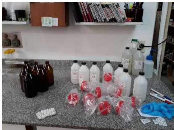
Fotos 11 a 14. Recuperación de las muestras para la calcinación (der). Set de envases para análisis en laboratorio (izq). Abajo: Placas para determinación microbiológica de unidades formadoras de colonias.
