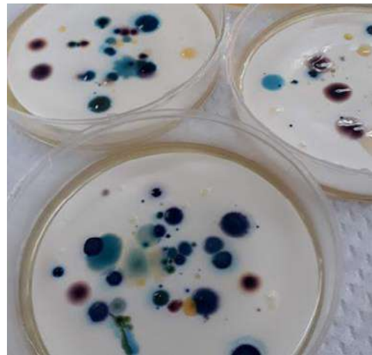
Foto LA5: Placas para determinación de UFC/100ml por filtración por membrana
