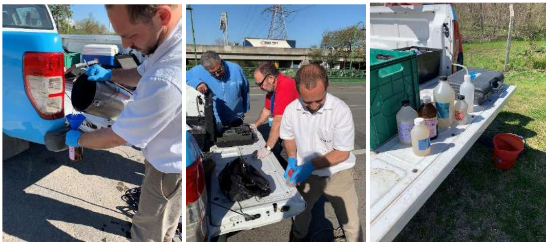
Fotos CA6 – Llenado de envases para acopio de la muestra de agua para distintos analitos.
