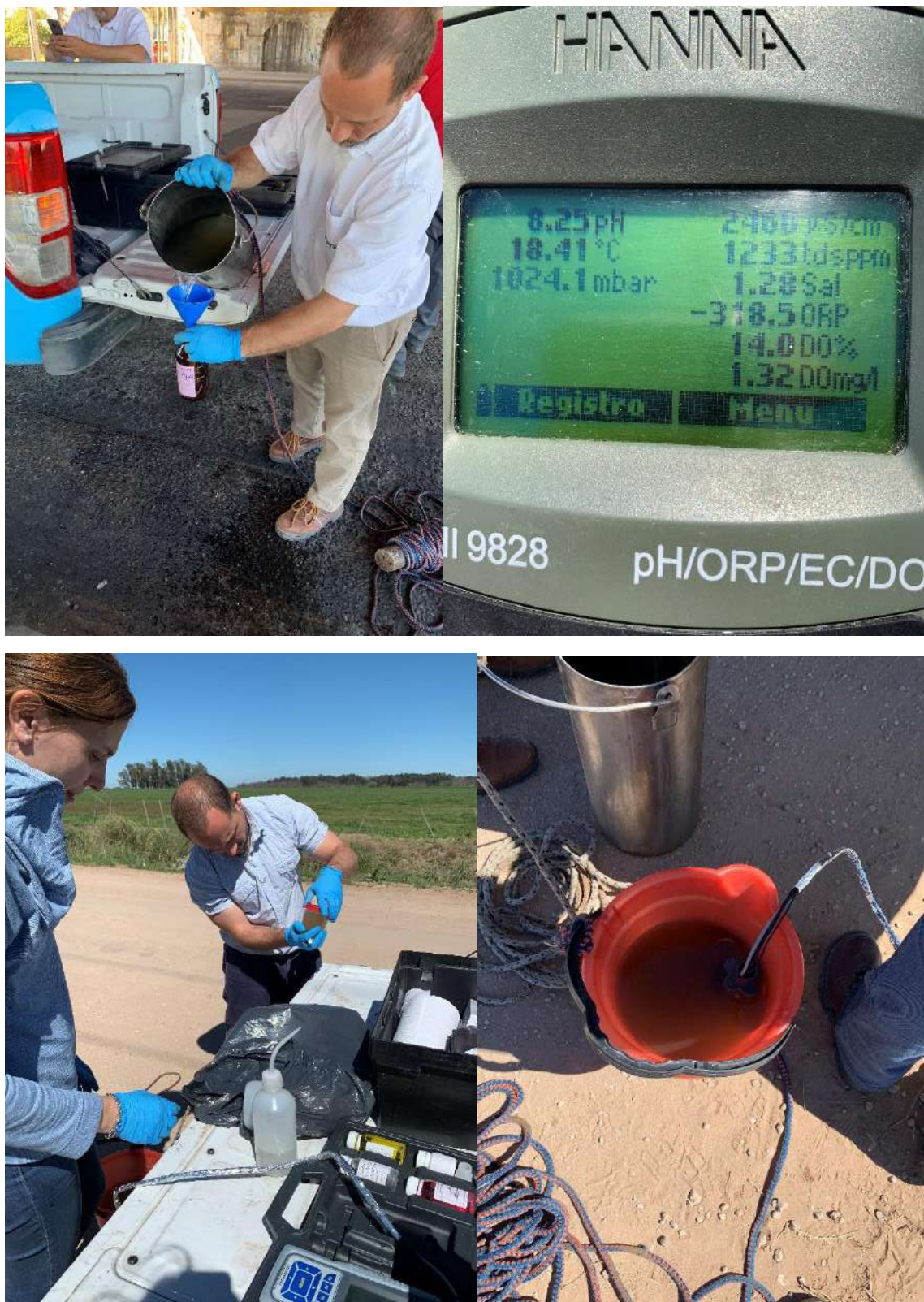
Fotos 7 a 10. Uso de sonda multiparamétrica, llenado de envases y acondicionamiento para el posterior análisis en laboratorio.
