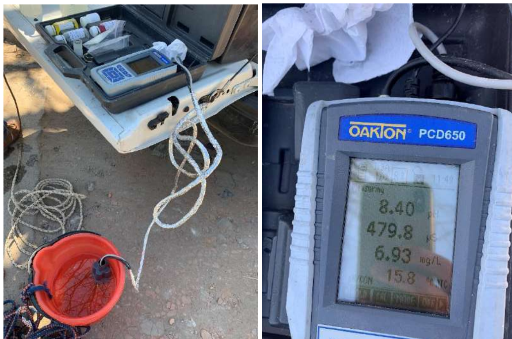
Fotos CA5 – Detalle de uso y display de sonda multiparamétrica durante la Campaña.
