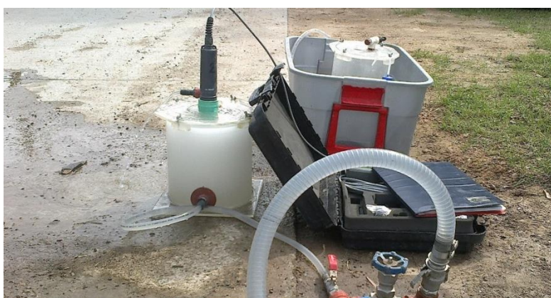
Figura 2.7. Equipo para registros de campo en pozos de monitoreo.
