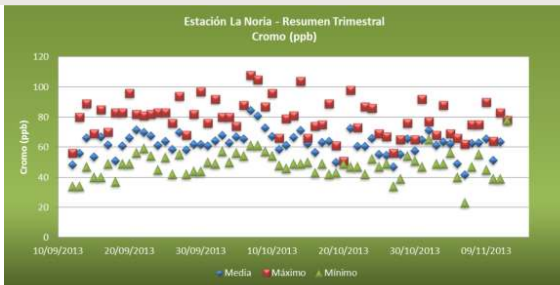
Figura 1.3.5. Concentraciones medias, máximas y mínimas diarias en partes por billón (equivalente a microgramos por litro ( \mu\text{g/l} )) de Cromo Total medidos en el período 12/09/2013-11/11/2013.
