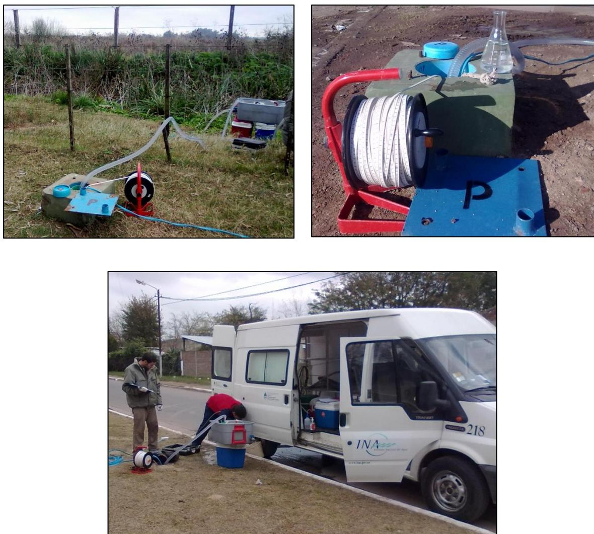
**Figura 2.11** . Imágenes del muestreo de calidad y profundidades de las aguas subterráneas ejecutado por el Instituto Nacional del Agua (INA).
