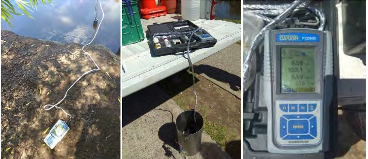
Fotos CA5 – Detalle de uso y display de sonda multiparamétrica OAKTON PCD 650 durante la Campaña.
