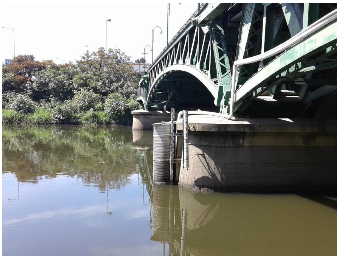
Foto 2. Detalle de la escala hidrométrica sobre el Río Matanza.
