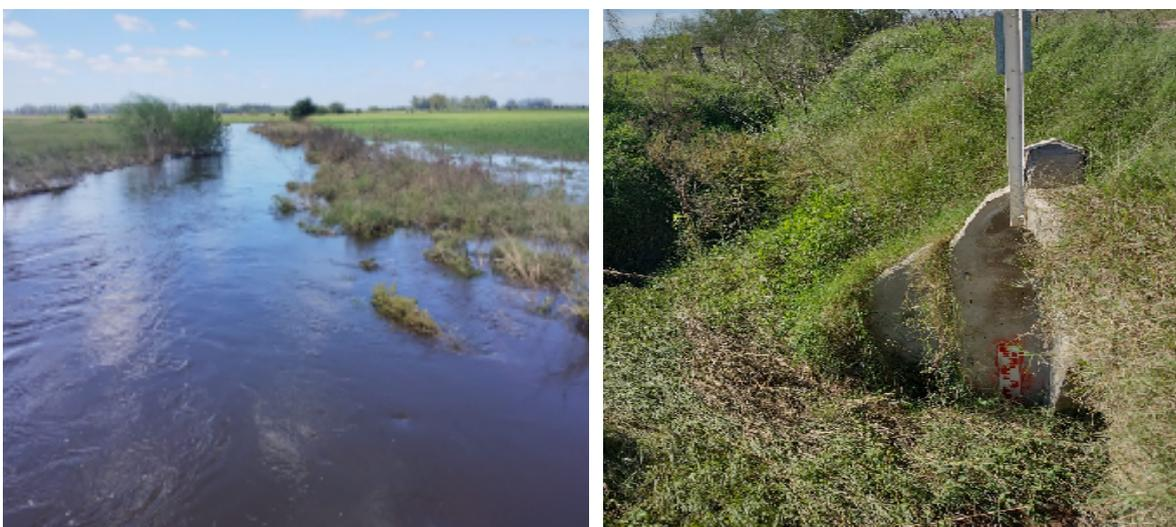
**Figura 6 y 7.** Desborde del Arroyo Rodríguez (Foto izquierda, fecha 21-03-2024) y escala en punto de monitoreo A03 parcialmente cubierta por sedimentos y vegetación (Foto derecha, fecha 19-04-2024)
