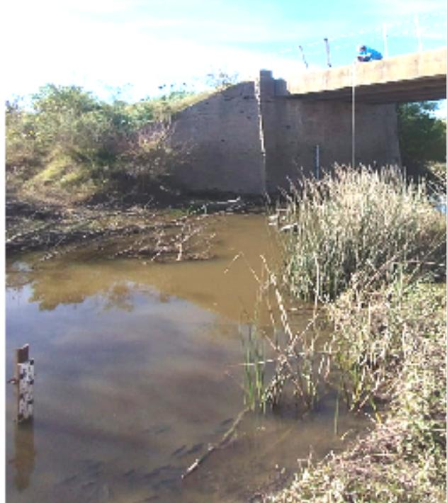
**Figura 3 y 4** .Mediciones de agua superficial en nuevo sitio de monitoreo para este estudio (A04). Corresponde al punto de monitoreo con escala existente de la Red de Estaciones y Puntos de Monitoreo de Agua Superficial de ACUMAR (EMM38) . Fecha 15-05-2024
