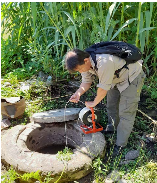
Imagen 8. Sondeo de nivel de agua en pozo existente en la parcela 1191 B.
