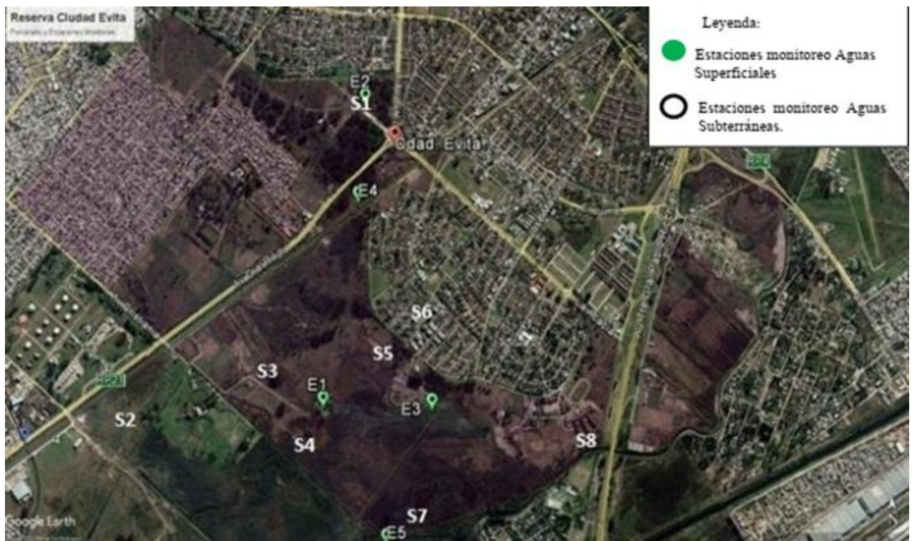
Imagen 22. Ubicación tentativa de pozos piezométricos (elaboración INA) en relación a los puntos de monitoreo de agua superficial y sedimentos en humedales (Coord. Calidad Ambiental, ACUMAR)
