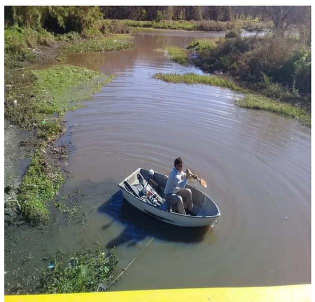
**Figura 3.** Ensayos de batimetría en arroyos en la Reserva Laguna de Rocha
