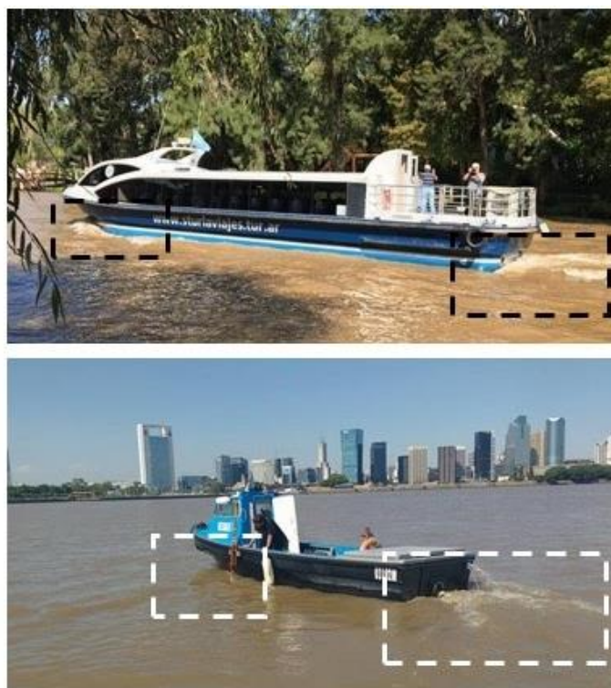
Figura 4.1. Estructuras de flujo generadas por oleaje (por delante) y propulsión (por detrás)
