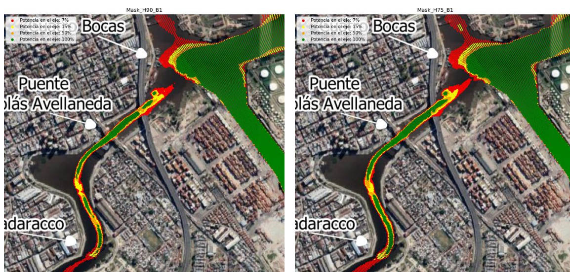
Figura 5.3. Diferencia de tensiones de corte máximas para la embarcación Tipo 1 entre Cuatro Bocas y Vuelta de Badaracco para permanencias del 90% (izquierda) y 75% (derecha).
