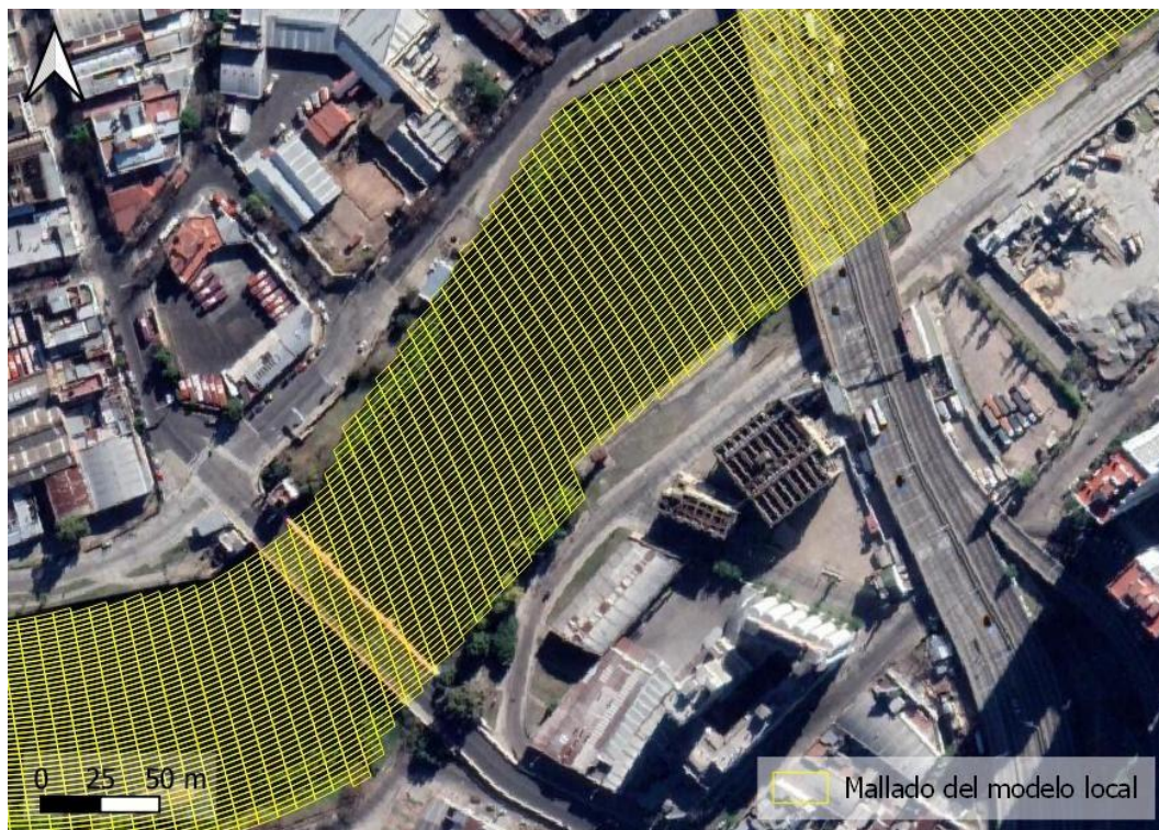
Figura 2.3. Detalle de la malla del dominio del modelo local.
