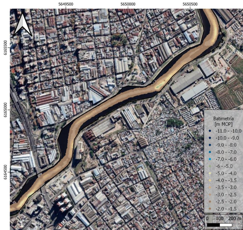
b) Tramo Puente Barraca Peña - Viejo Puente Pueyrredón Figura 5.8. Detalles de la batimetría en el área de estudio
