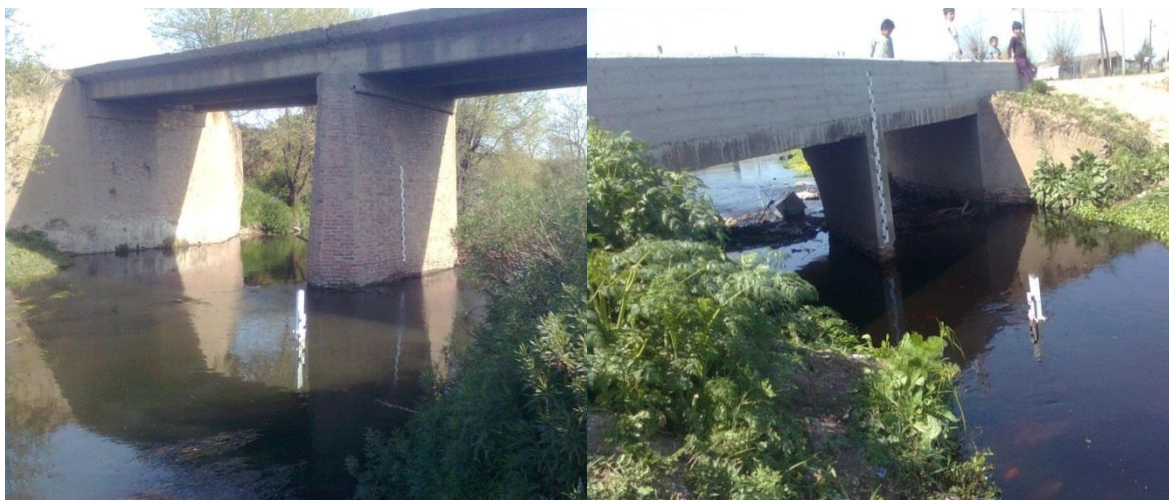
Figura 1.4. Instalación de escalas hidrométricas en la Cuenca Matanza Riachuelo.
